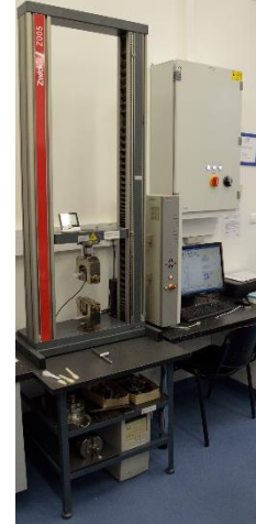
7. ábra Zwick Z005 típusú univerzális szakítógép
